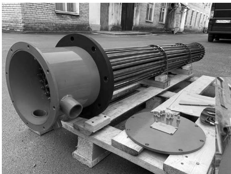
Блок для подогревания масла на 100 кВт
