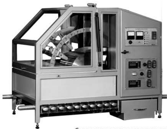
Сепаратор электростатический барабанного типа ЭЛКОР-1
